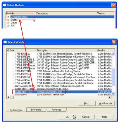
Figure 7-4. Select "ETHERNET-MODULE".
